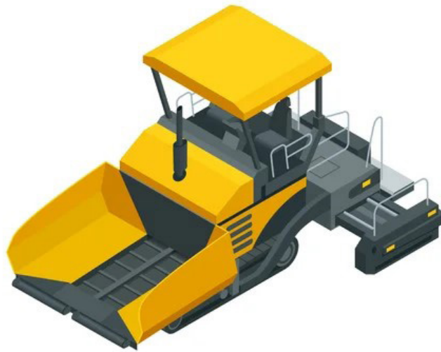
รูปที่ 2. เครื่องปูวัสดุผิวทางลาดยาง
