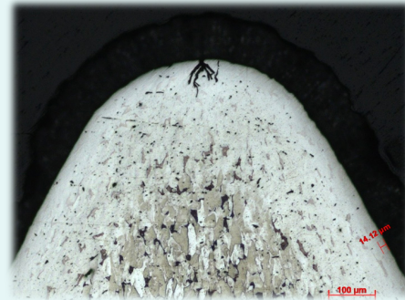
รูปที่ 15. แสดงภาพโครงสร้างจุลภาคสลักเกลียว (Screw thread) ที่ผ่านการกระบวนการรีดขึ้นรูป และผ่านกระบวนการทาง ความร้อน
