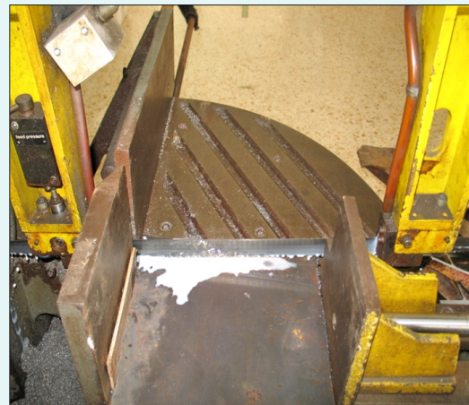
รูปที่ 1. แสดงการตัดชิ้นงานด้วยเลื่อยสายพานตัดแนวนอน
