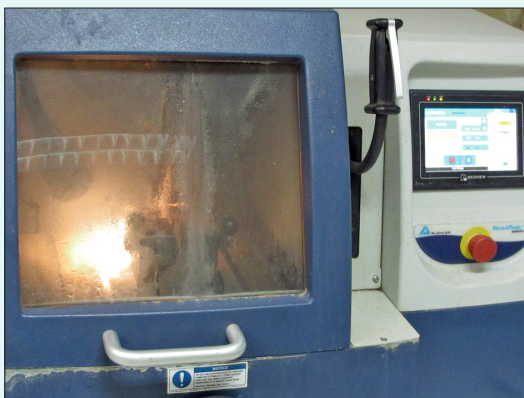
รูปที่ 2. แสดงการตัดชิ้นงานด้วยเครื่องตัด Cut-Off Machine
