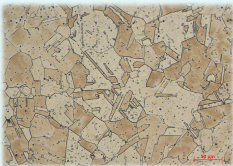
รูปที่ 17. แสดงภาพโครงสร้างจุลภาคของเหล็กกล้าไร้สนิม (Stainless steel)
