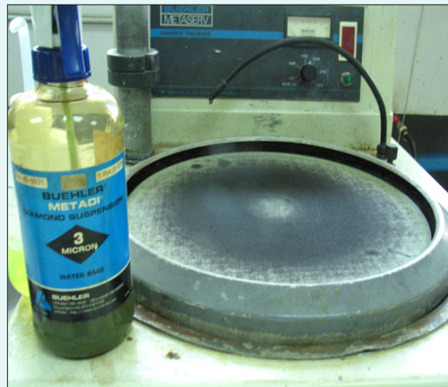
รูปที่ 10. แสดงภาพการขัดด้วยผงเพชร (Diamond compound) ขนาด 3 ไมครอน
