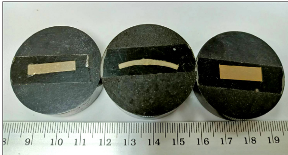
รูปที่ 3. แสดงชิ้นงานที่ขึ้นเรือนแบบร้อน (Hot mounting)
