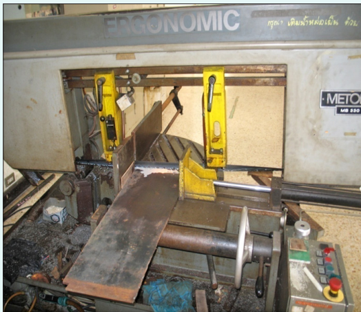
รูปที่ 1. แสดงการตัดชิ้นงานด้วยเลื่อยสายพานตัดแนวนอน
