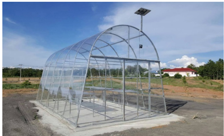
รูปที่ 4. ต้นแบบตู้อบพลังงานแสงอาทิตย์ อำเภอบ้านโฮ่ง จังหวัดลำพูน
