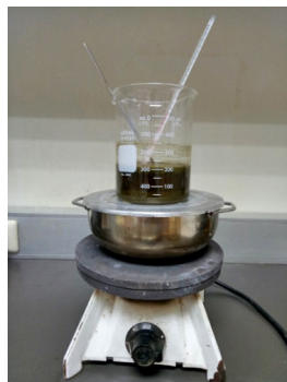
รูปที่ 5. ต้มบนอ่างน้ำร้อนจน อุณหภูมิ 70 - 80 องศาเซลเซียส
