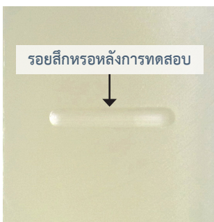
รูปที่ 1. ตัวอย่างวัสดุที่ใช้ทางการแพทย์ทดสอบการสึกหรอแบบ Reciprocating Ball-on-Flat
