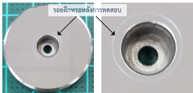
รูปที่ 2. ตัวอย่างวัสดุทดสอบการสึกหรอแบบ Pin-on-Disk
