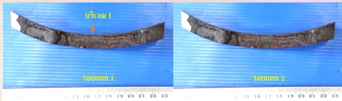
รูปที่ 1. ผิวรอยแตก 1 และรอยแตก 2 ถูกล้างในห้องปฏิบัติการเพื่อตรวจสอบสภาพผิวแตก พบรอย Ratchet Marks ที่แสดงจุดเริ่มต้นรอยแตกจากผิวด้านนอกท่อและขยายตัวสู่ผิวด้านในท่อตามแนวเส้นโค้งของรอย Beach Marks
