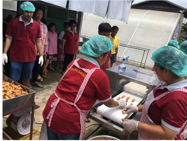
รูปที่ 4. การทดสอบการรีดแบนกล้วยตากด้วยเครื่องต้นแบบ วว.
