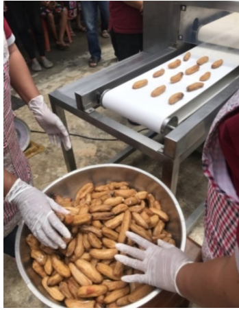
รูปที่ 4. การทดสอบการรีดแบนกล้วยตากด้วยเครื่องต้นแบบ วว.
