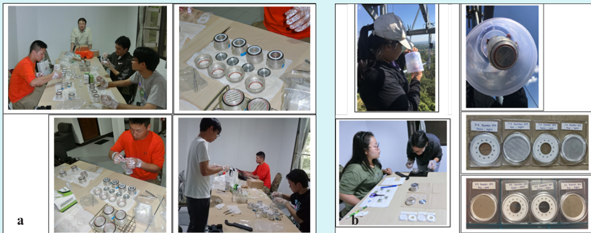
รูปที่ 7. การเตรียมแผ่นกรองเก็บฝุ่นละอองในอิมเพกเตอร์คัตขนาด
