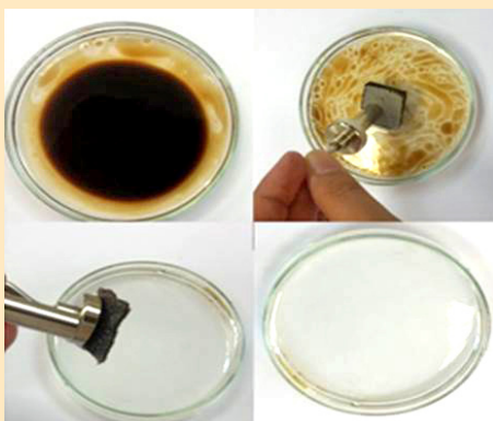
การดูดซับน้ำมันที่อยู่บนผิวน้ำของโพลียาง ที่มีอนุภาคนาโนของเหล็กออกไซด์
