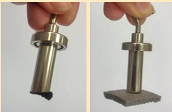
รูปอนุภาคนาโนของเหล็กออกไซด์และโพลียาง ที่มีอนุภาคนาโนของเหล็กออกไซด์ที่ติดติดกับแม่เหล็ก
