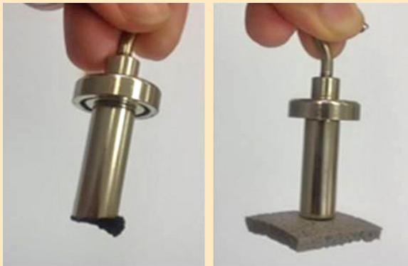
รูปอนุภาคนาโนของเหล็กออกไซด์และโฟมยาง ที่มีอนุภาคนาโนของเหล็กออกไซด์ที่ดูดติดกับแม่เหล็ก
