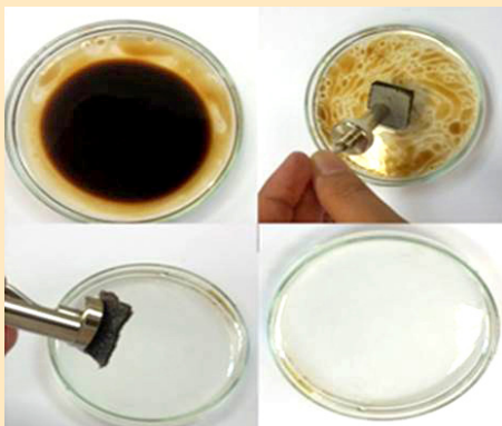
การดูดซับน้ำมันที่อยู่บนผิวน้ำของโฟมยาง ที่มีอนุภาคนาโนของเหล็กออกไซด์
