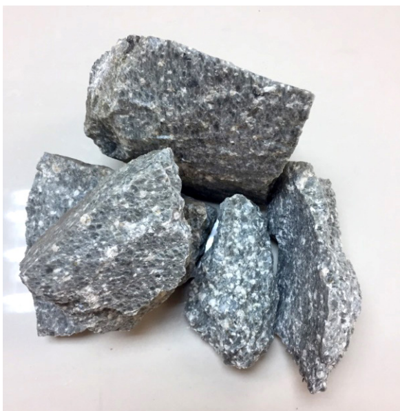
รูปที่ 2 แร่หินเพอร์ไลต์ลักษณะเป็นก้อนสีเทาดำ (ซ้าย) ก่อนที่จะนำไปบดและเผาที่อุณหภูมิสูงจนได้ผงเพอร์ไลต์สีขาว (ขวา)
