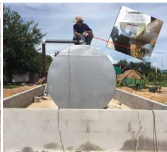
รูปที่ 2 การทดสอบการรั่วซึมของท่อและถังเก็บน้ำมันเชื้อเพลิงเหนือพื้นดินขนาดใหญ่ตามแนวนอน
