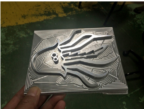
รูปที่ 10 แม่พิมพ์ที่ผ่านการขึ้นรูปด้วยเครื่องจักร CNC
