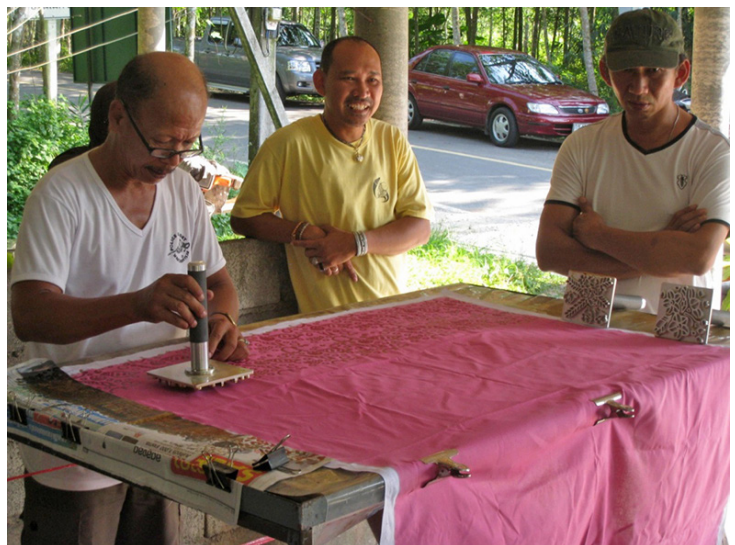
รูปที่ 13 การพิมพ์ลายผ้าบาติกด้วยแม่พิมพ์ CNC
