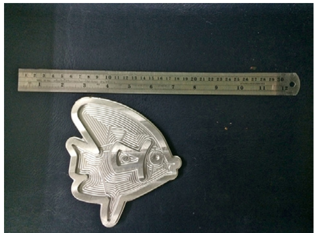
รูปที่ 10 แม่พิมพ์ที่ผ่านการขึ้นรูปด้วยเครื่องจักร CNC
