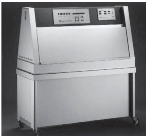
รูปที่ 3 ชุดอุปกรณ์การทดสอบและหลักการการทดสอบโดยจำลองสภาพอากาศด้วยแสงยูวีและความชื้น
